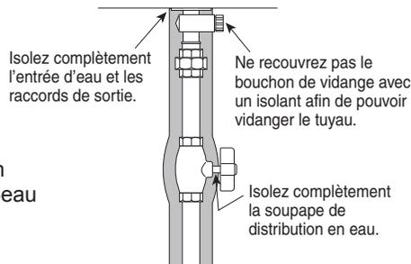
Si l'unité est installée sur un toit pour alimenter en eau les niveaux inférieurs, assurez-vous que la pression de l'eau distribuée à l'unité ne descend pas en dessous de 29psi. Il pourra être nécessaire d'installer un système de pompage pour garantir que la pression de l'eau est maintenue à ce niveau.
