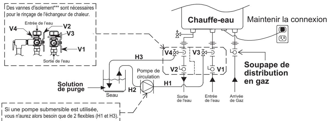
\*\*\*\* Les clapets d'isolation peuvent être achetés comme accessoire auprès d'un revendeur Noritz agréé. Ils permettent un test de diagnostic complet et une purge facile du système. Prenez contact avec Noritz America pour de plus amples informations. (866-766-7489)
