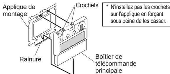
6. Fixez la télécommande en place avec les vis machine.
