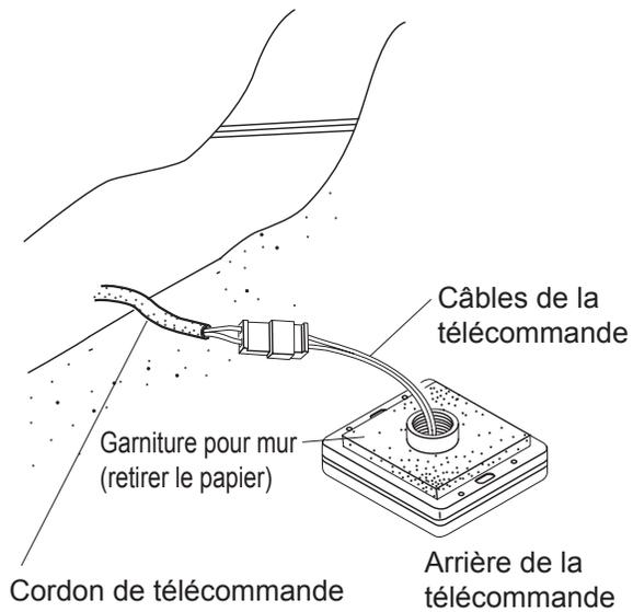
3. Retirez le couvercle de la télécommande, marquez l'emplacement des trous de vis et percez les trous pour les ancrages pour mur.
